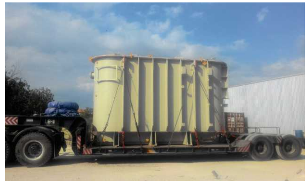
Tank Transformer 60 MVA PT Perusahaan Listrik Negara
